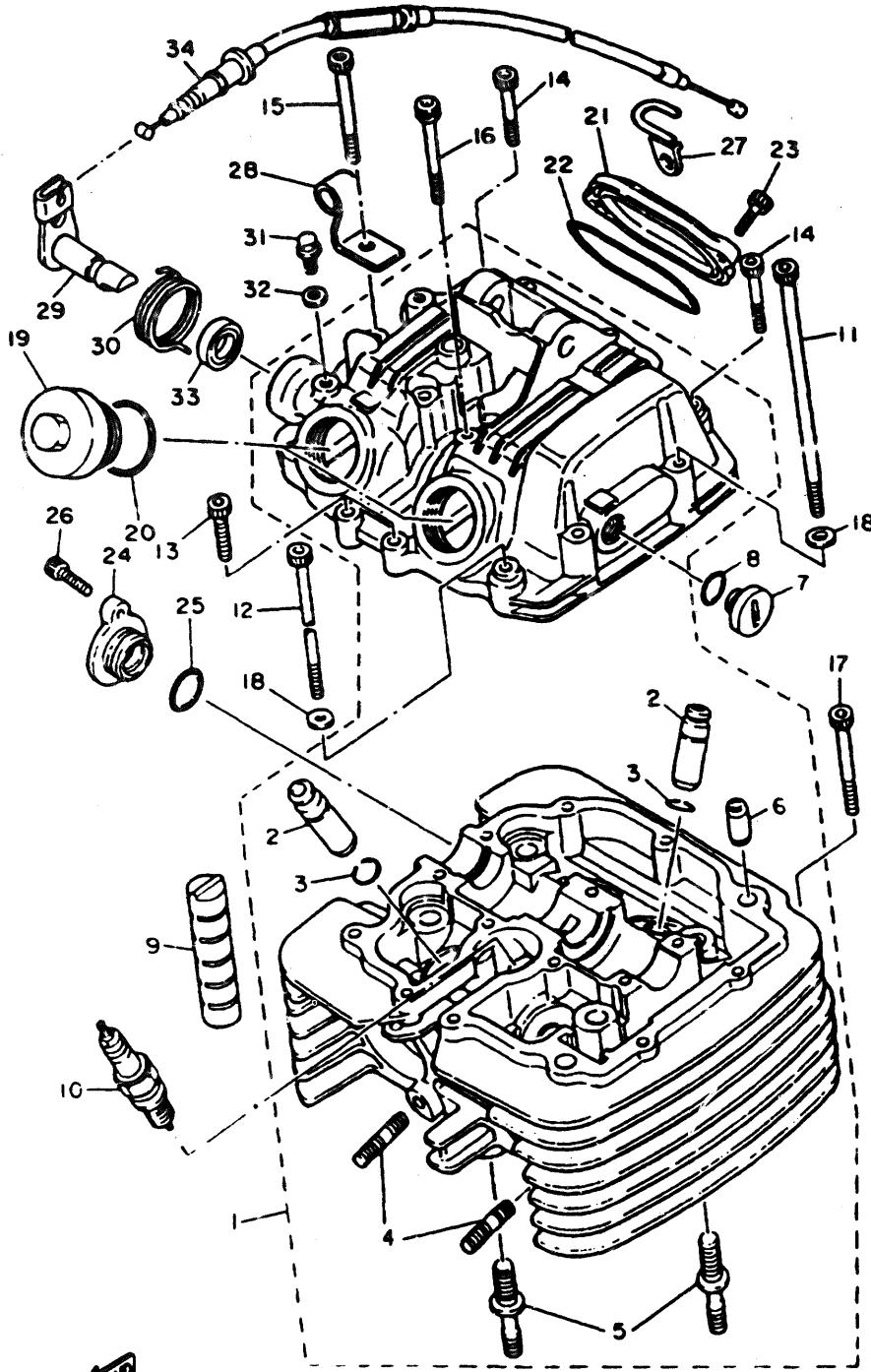
FIG. 1 CYLINDER HEAD
